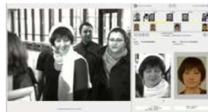
FaceVACS-VideoScan de Cognitec sait détecter plusieurs visages approchant d'une caméra et les comparer aux images stockées en base de données.
