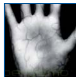
Les capteurs infrarouges prennent une série d'images du réseau veineux
